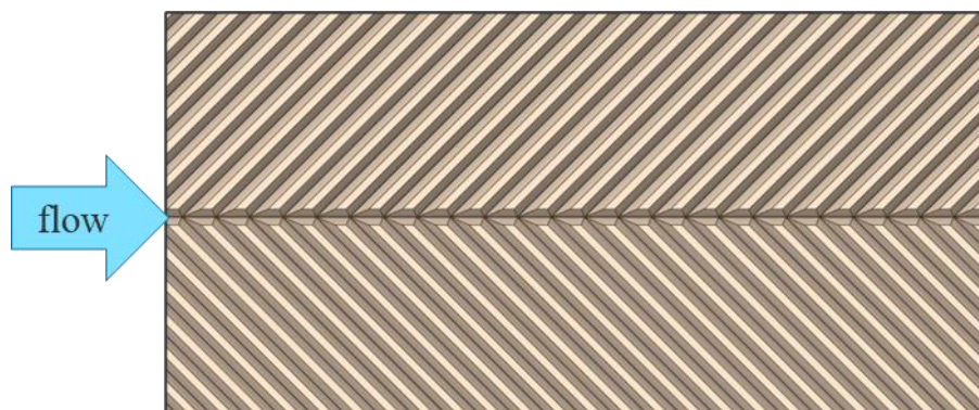
図 3.3 提案するシェブロンフィンの構造
