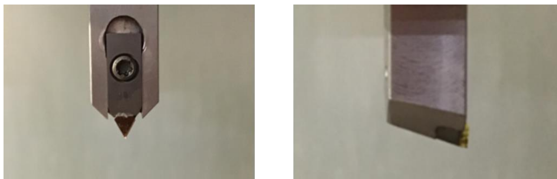
図 3.5 加工治具(ダイヤモンドバイト)
