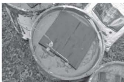
Fig.9. 田圃埋設用微生物燃料電池
