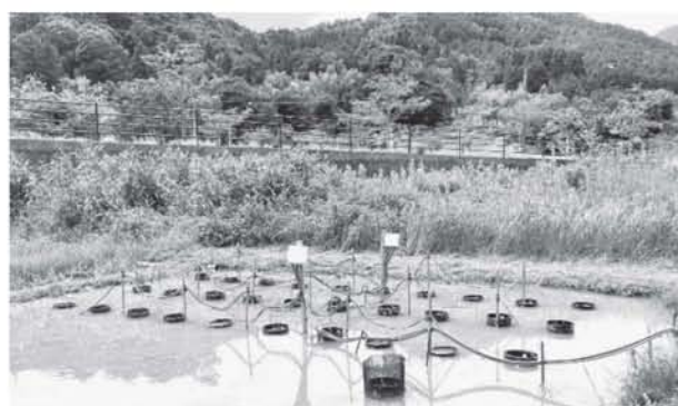
Fig.16. 田圃南側に設置した電池群(32個)
