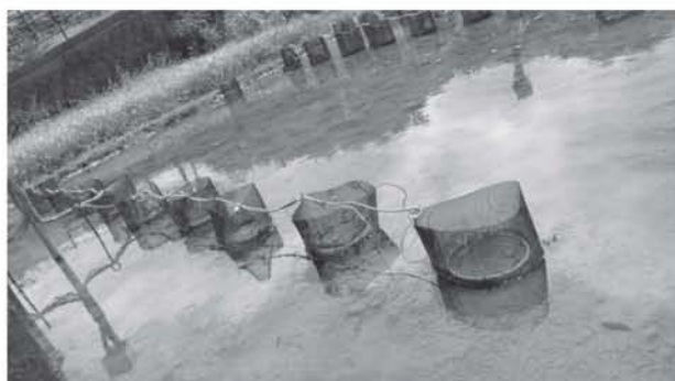
Fig.10. 田圃に埋設した微生物燃料電池群
