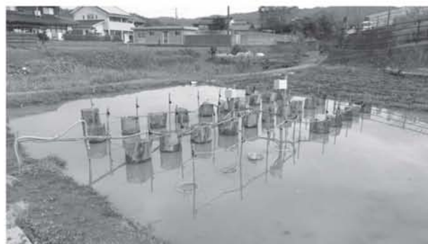
Fig.11. 田圃北側に設置した電池群
