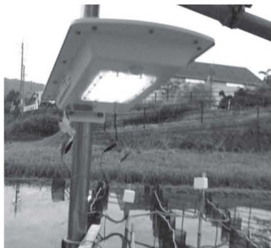
Fig.14. 微生物発電による街路灯点灯
